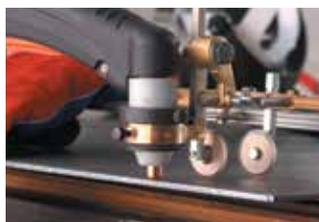
Geringes Gewicht, minimale Einrichtzeit, keine Kraft erforderlich. Magnetische Halterungen gewährleisten eine sichere Positionierung und eine einfache Bedienung. Optionale Ansaugplatten für antimagnetische Anwendungen (Aluminium, Edelstahl) erhältlich. Das Schneidföhrungs-Kit enthält: 1,2 m-Standard-Brennerhaltereschiene mit Buchse, Hochleistungsmagnete (jeweils 2 Stück), Gleitmontageräder und Befestigungsteile. Optional sind 1,2 m Verlängerungen (9-7971) verfügbar.
