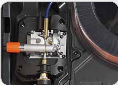
Die Kempact 181/251-Modelle verfügen über den GT02-Drahtvorschub mit zwei Rollen.
